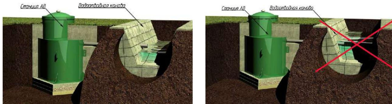
При выборе данного способа водоотведения необходимо обеспечить свободное отведение очищенной воды от выпуска трубопровода, необходимо полностью исключить подтопление выпуска. В противном случае, в летний период, трубопровод будет заливаться и засоряться, а Станция будет подвержена обратному затоплению водами с точки сброса. В зимний период, трубопровод и точка сброса будут промерзать. Такие условия работы оборудования приведут к аварии.
